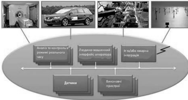
Рис. 1.2.3.4. Протокол DDS реалізує архітектуру публікації і підписки.
