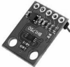
Рис.1.3.3.8. Датчик освітленості BH1750.
